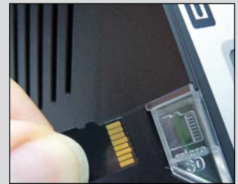
MicroSD-Karte zur Parametrisierung der i-CON pico
