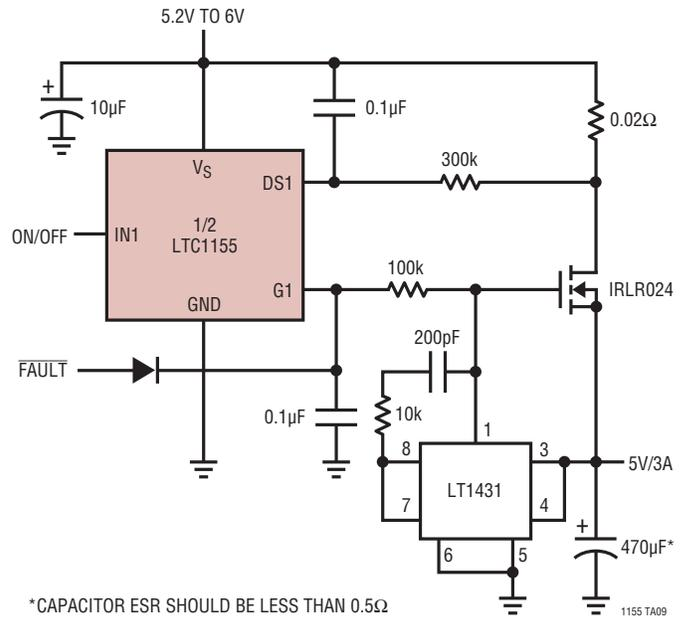
\*CAPACITOR ESR SHOULD BE LESS THAN 0.5Ω
