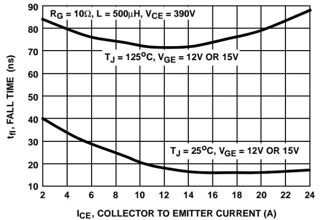
FIGURE 12. FALL TIME vs COLLECTOR TO EMITTER CURRENT
